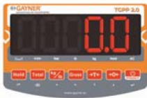
Detalle display indicador de carga
